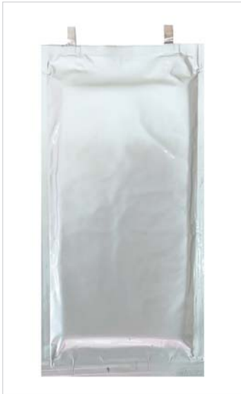
Pierwszy prototyp baterii litowo-siarkowej zaprezentowany przez zespół poznańskich naukowców
